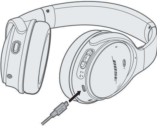
**注意：**充电时，电池指示灯会闪烁琥珀色光。电池充满电后，电池指示灯呈绿色光亮起。
