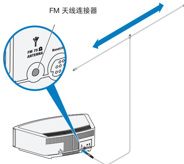
**注意：**许多 FM 电台也传输垂直极化信号或水平极化信号。如果水平天线位置不能提供较好的接收效果，请尝试在垂直方向上悬挂天线。
