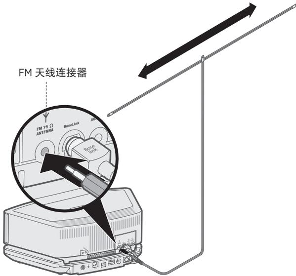
**注意：**许多 FM 电台也传输垂直极化信号或水平极化信号。如果水平天线位置不能提供较好的接收效果，请尝试在垂直方向上悬挂天线。
