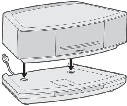
2. 将 SoundTouch® 基座线缆插入 Bose link 连接器中。
