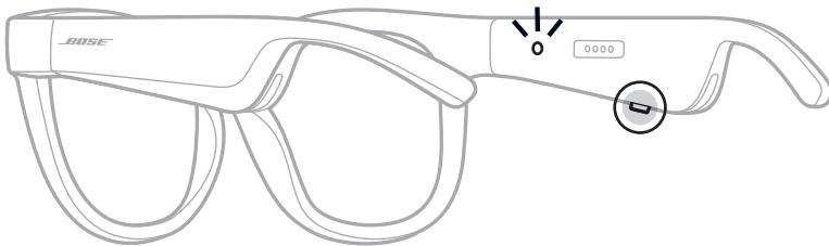
**注意：**太阳眼镜发货时带有部分电量，首次使用前可能需要唤醒。要唤醒太阳眼镜，请将太阳眼镜通电 2 秒钟，然后断开连接（请参见第 21 页）。然后，尝试重新开机。
